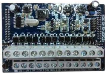
APV-A310是与DX500系列变频器配套使用的食品机械扩展卡
