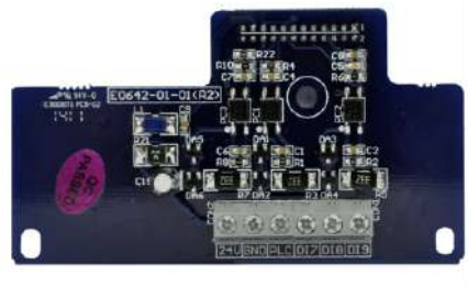
IOV-D112适用于DX系列变频器
