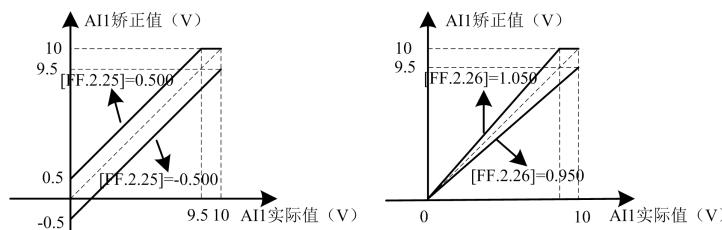
图 7-18-A AI1 零偏矫正曲线
