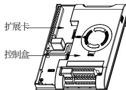
图 3-3 扩展卡的拆卸示意图
