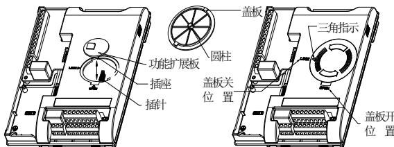
图 3-4 功能板的安装拆卸示意图
