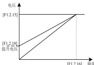
图 7-8-B 恒转矩曲线转矩提升示意图
