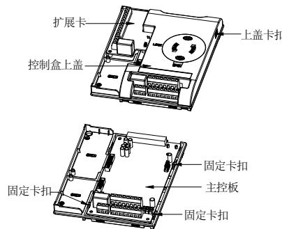
图 3-5 主控板更换拆装示意图
