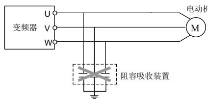
图 4-1 输出端禁止连接阻容吸收装置
