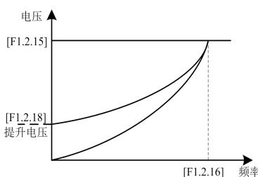
图 7-8-A 降转矩曲线转矩提升示意图
