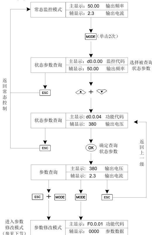
图 5-1 状态参数查询示意图
