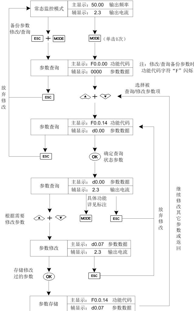
图 5-2 参数查询与修改示意图
