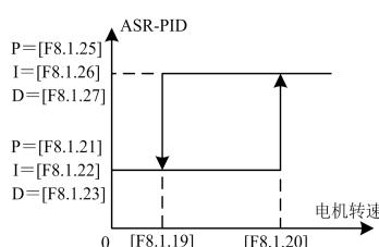
图 7-16-A 双 PID 参数 (滞环切换)
