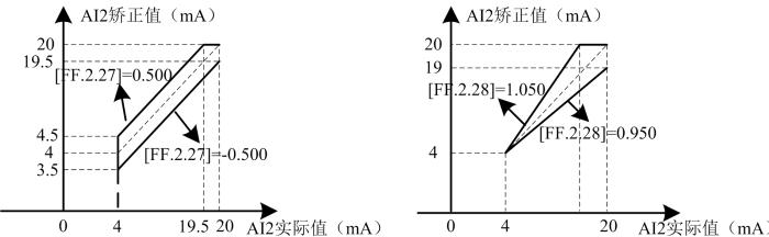
图 7-18-C AI2 零偏校正曲线
