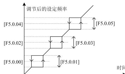
图 7-15 跳跃频率输出示意图
