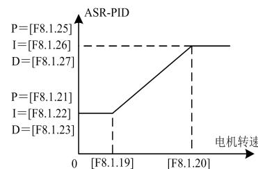
图 7-16-B 双 PID 参数 (连续切换)
