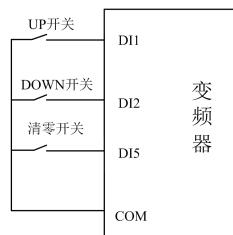
图 7-4 端子 UP/DW 接线示意图
