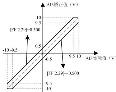
图 7-18-E AI3 零偏校正曲线
