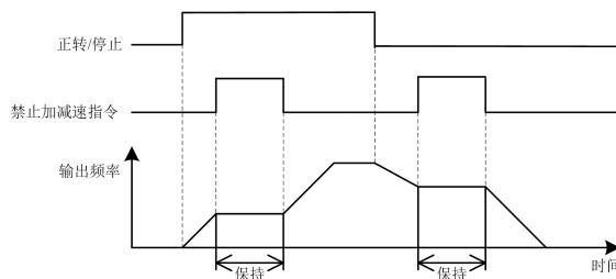
图 7-11 禁止加减速示意
