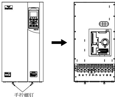
图 3-5 钣金盖板的拆卸安装示意图
