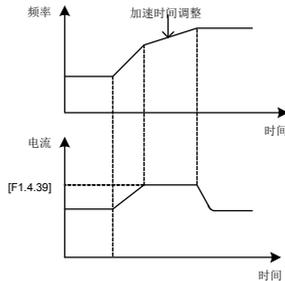
图 7-30 加/减速电流限制示意图
