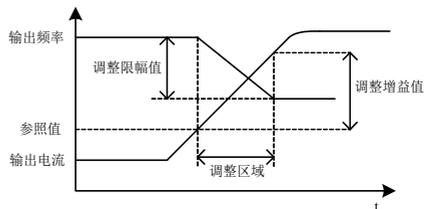
图 7-46 动平衡变量设置示意图
