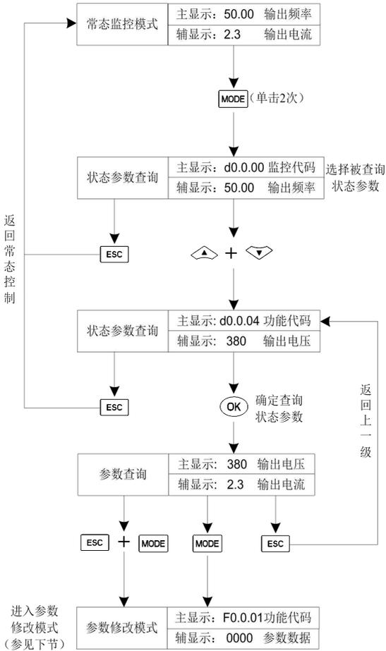
图 5-2 状态参数查询示意图
