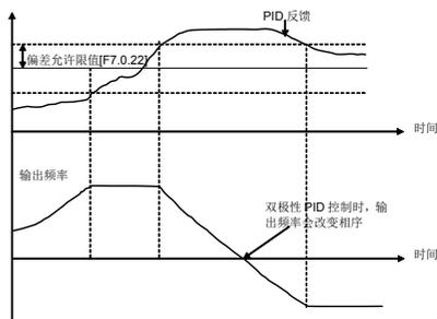
图 7-55-B 双极性 PID 控制方式
