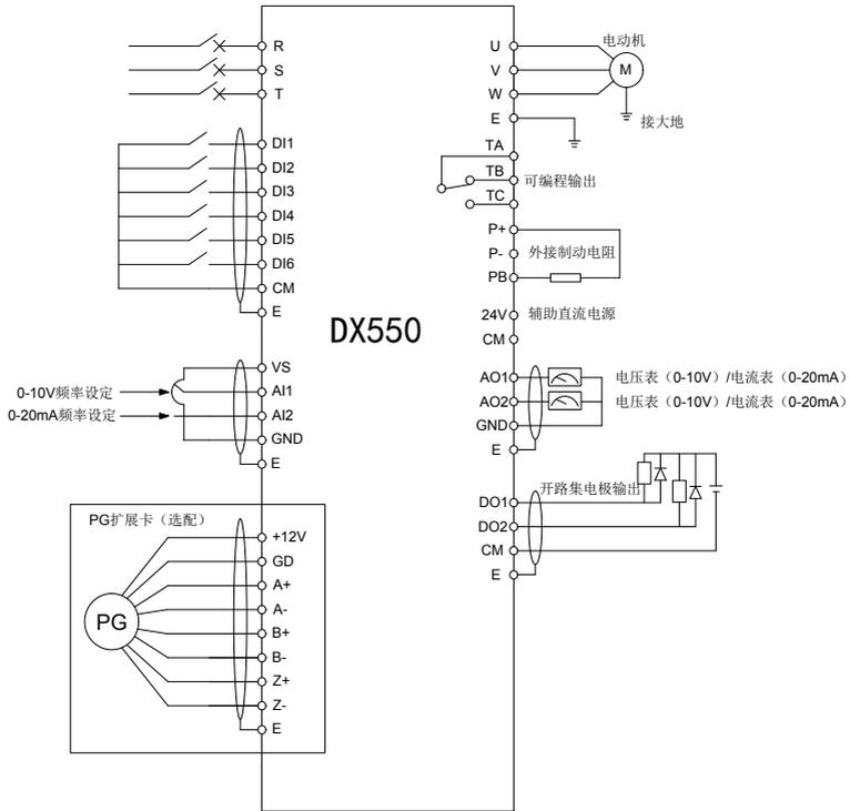
图 4-2 DX550 系列变频器基本接线
