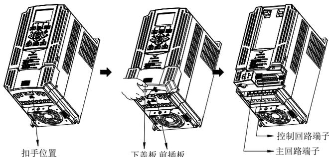
图 3-4 塑壳盖板的拆卸安装示意图
