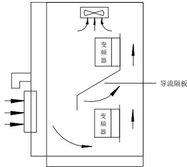
图 3-3 两台变频器上下安装间隔
