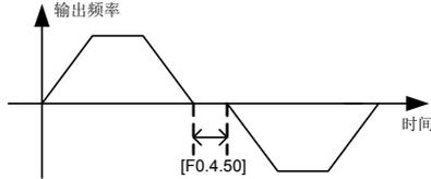
图 7-21 正反转过渡死区示意图
