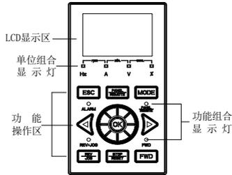
图 5-1-B 双行 LCD 标准操作面板
