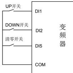
图 7-12 端子 UP/DW 接线示意图
