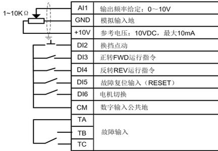
图 7-4 机床主轴驱动宏 AI1 设定接线图
