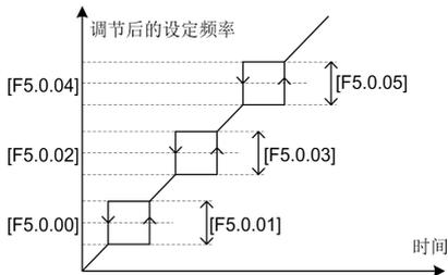
图 7-40 跳跃频率输出示意图
