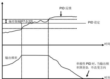
图 7-55-A 单极性 PID 控制方式
