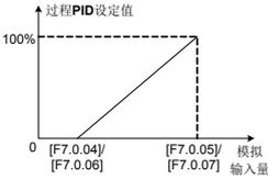
图 7-52 过程 PID 设定值定义示意图
