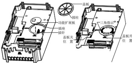
图 3-7-A I 类功能板的安装拆卸示意图
