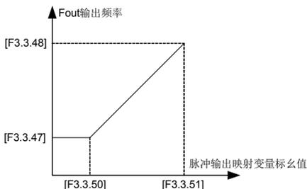
图 7-35 脉冲输出 Fout 特性曲线
