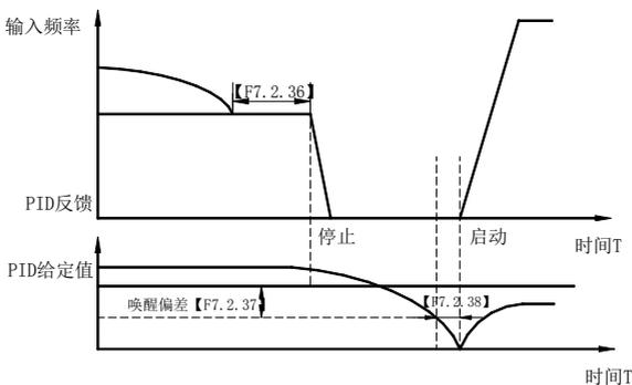
图 7-59 PID 睡眠功能示意图
