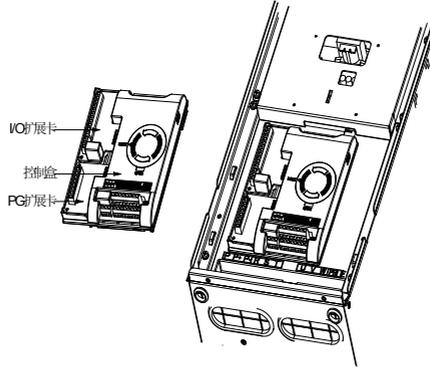
图 3-6 扩展卡的拆卸安装示意图
