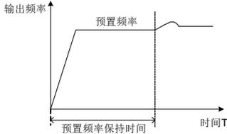
图 7-57 闭环预置频率运行示意图
