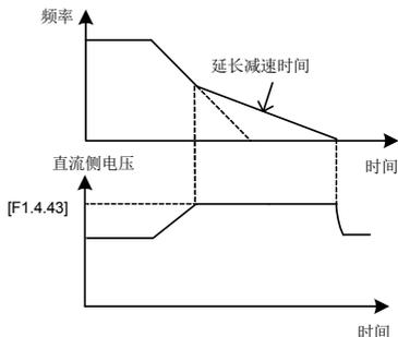
图 7-31-B 减速过程的过压抑制
