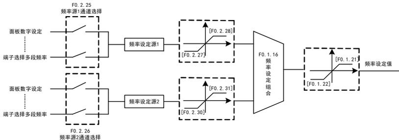
图 7-8 频率设定通道结构示意图
