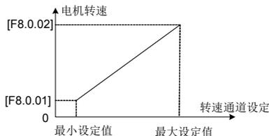
图 7-61 转速设定值和电机转速对应关系图
