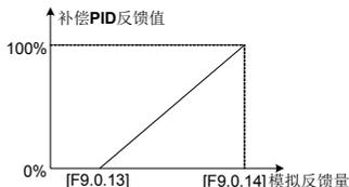
图 7-66 补偿 PID 反馈值定义示意图
