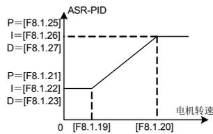
图 7-63-B 双 PID 参数 (连续切换)
