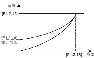
图 7-27-A 降转矩曲线转矩提升示意图
