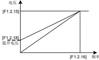
图 7-27-B 恒转矩曲线转矩提升示意图
