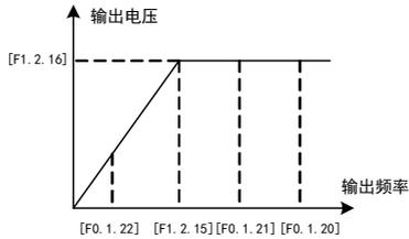
图 7-10 频率参数定义示意图
