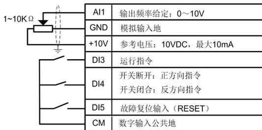
图 7-2-A 两线控制一 AI1 设定接线
