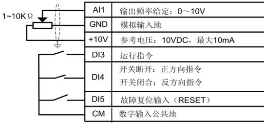
图 7-2-B 两线控制二 AI1 设定接线图
