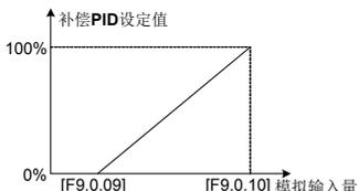
图 7-65 补偿 PID 设定值定义示意图
