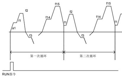
图 7-48-D 简易 PLC 运行连续循环模式
