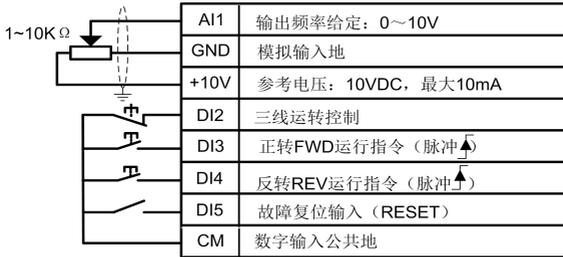
图 7-3 三线控制一/AI1 设定接线图
