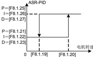
图 7-63-A 双 PID 参数 (滞环切换)
