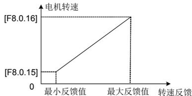
图 7-62 转速反馈值和电机转速对应关系图
