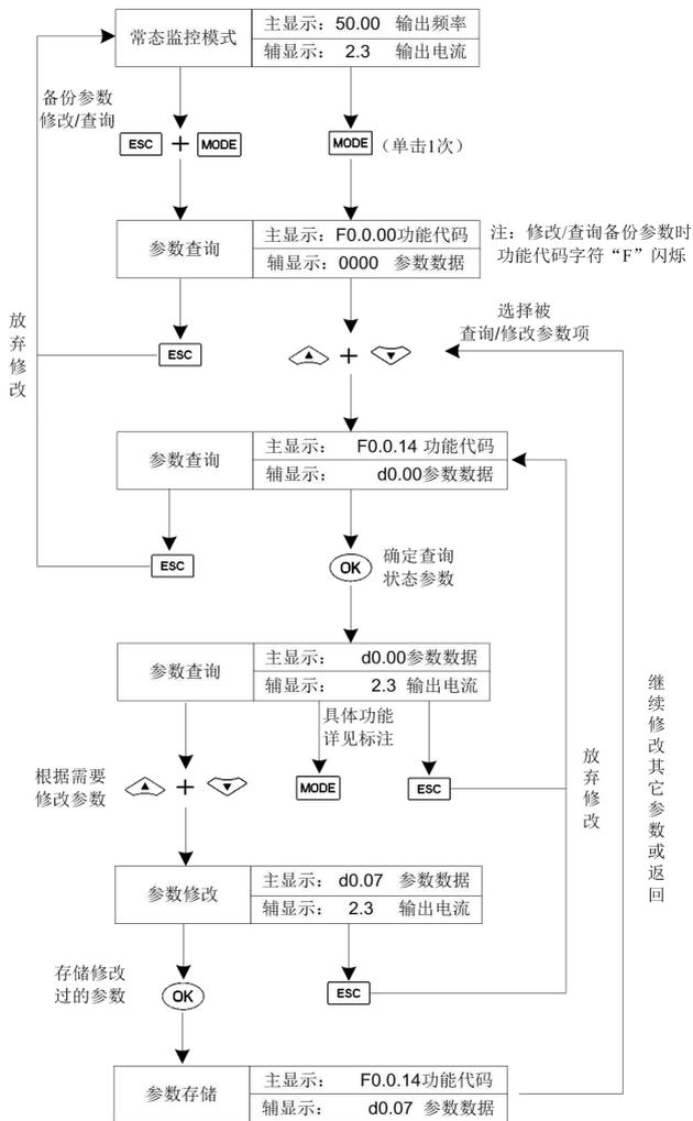
图 5-3 参数查询与修改示意图
