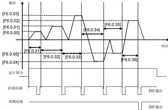
图 7-48-C 简易 PLC 运行单循环停机模式
