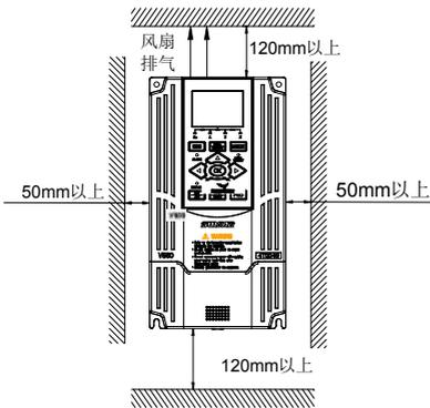
图 3-1-A 安装的间隔距离(30KW 及以下)
