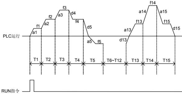
图 7-48-B 简易 PLC 运行单循环模式
