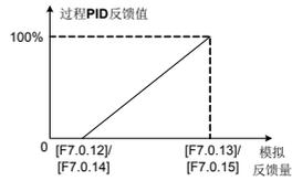
图 7-53 过程 PID 反馈值对应关系示意图
