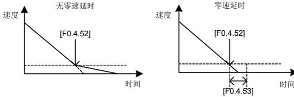
图 7-23 有无零速延时对比图
