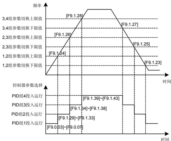
图 7-67 补偿 PID 参数切换示意图
