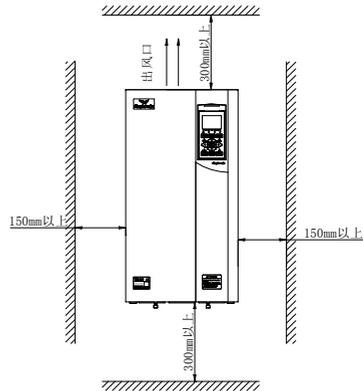
图 3-1-B 安装的间隔距离(37KW 及以上)
