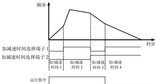
图 7-25 加、减速时间的外部端子选择方式
