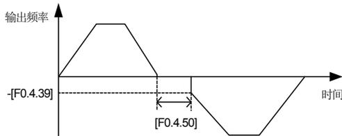
图 7-22 起动频率正反转切换示意图
