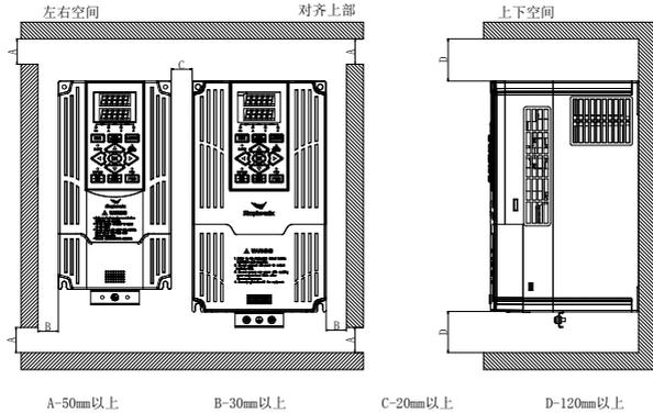
图 3-2 两台变频器（4.0KW 以上）左右安装尺寸
