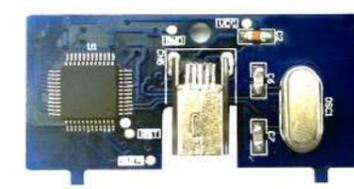
APV-F301和APV-B301是与DX系列/DL500系列/E580系列变频器配套使用的张力控制扩展卡，适用于拉丝机行业及收放卷控制等有关的场合。
