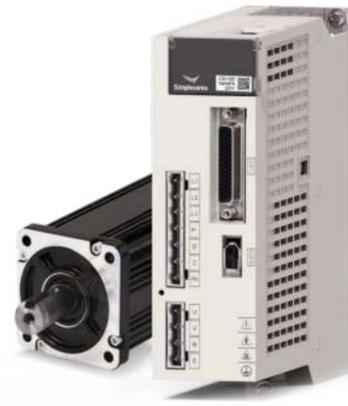
CD100系列伺服驱动器是四方电气在全新平台上研发的新一代经济型中小功率交流伺服控制单元，功率范围为：100W~7.5kW。具有集成度高、体积小、散热效果好、性能可靠、结构设计美观大方等特点。免调试功能搭配上位机软件，大幅提升了伺服系统对使用现场的适应能力，广泛用于数控加工、包装印染、纺织木工、新能源、工业机器人等众多领域。
