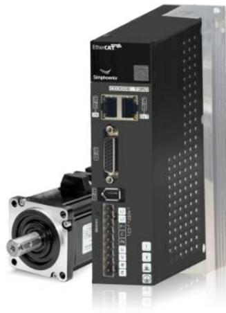
CD300系列是四方电气研制的一款通用型高性能的交流伺服驱动器，采用以太网通讯接口，支持EtherCAT通讯协议，配合上位机可实现多台伺服联网运行。提供了单参数自整定、1秒惯量测定、在线负载测定、共振抑制、末端振动抑制、多轴控制环同步等功能，使得伺服控制简单易用。该产品适用于包装、食品生产、数控切割、纺织、机床、木工雕刻等典型行业的自动化设备，以高性能方案实现快速且精准的位置控制，速度控制与转矩控制。
