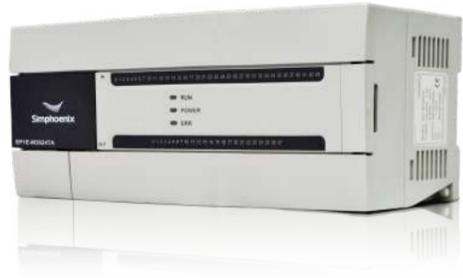
EP1E系列可编程逻辑控制器是一款微型高性能通用以太网型PLC，其结构小巧，功能强大，具有数据处理、模拟量处理、网络通信，CANopen通信，USB通信，高速计数和高速脉冲输出定位控制功能，还具有SD卡工程存储以及存储卡固件升级功能，同时支持多扩展模块以及丰富的BD卡扩展功能。
