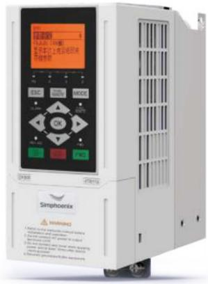
DX500为四方电气打造的新一代面向市场的高性能闭环矢量变频器，其小巧的机身使其装配更简单，能覆盖更多对机器结构有要求的客户。全面继承我司高端变频器的闭环矢量、开环矢量、V/F控制算法，以及丰富多样的扩展接口、上百种警告与报警，内置永磁同步电机参数，用于高精度、高力矩要求等场合，是一款性能优越、保护功能齐全的高性能闭环矢量变频器。
